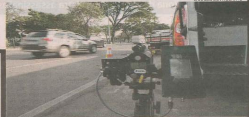
Aparelho envia ondas eletromagnéticas que captam a aproximação de veículos
