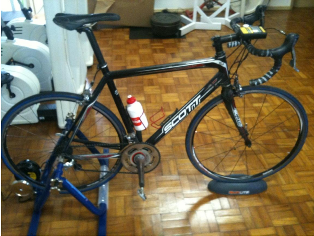
Figura 4 - Bicicleta de ciclismo montada com o ciclossimulador ComputrainerLab e instrumentada com o medidor de potência SRM.
