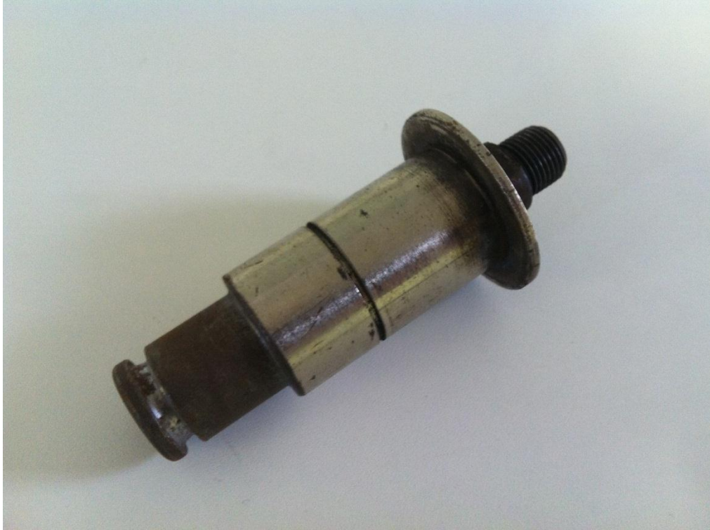
Figura 5 - Eixo para fixar os contrapesos de 2,5 e 5,0 Kg.
