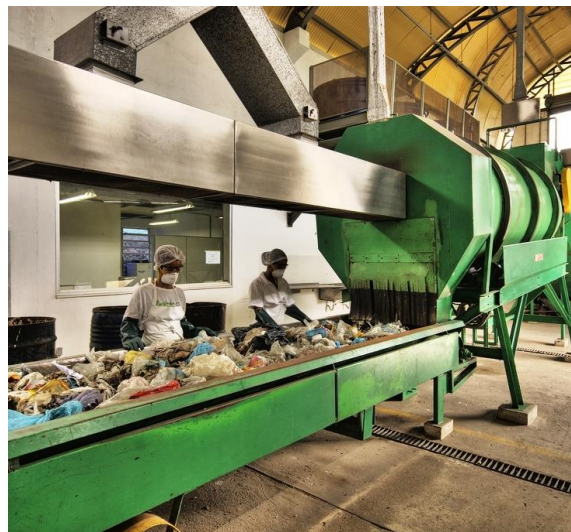
Figura 21 – Processo de seleção manual/mecânica de materiais com potencial de reciclagem. Fonte: USINAVERDE, 2011.
