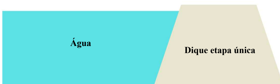
Figura 1 - Configuração de Barragem construída em etapa única
