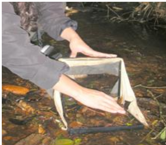
Fotografia 3: Coleta da fauna com amostrador Surber. Fonte: O autor
