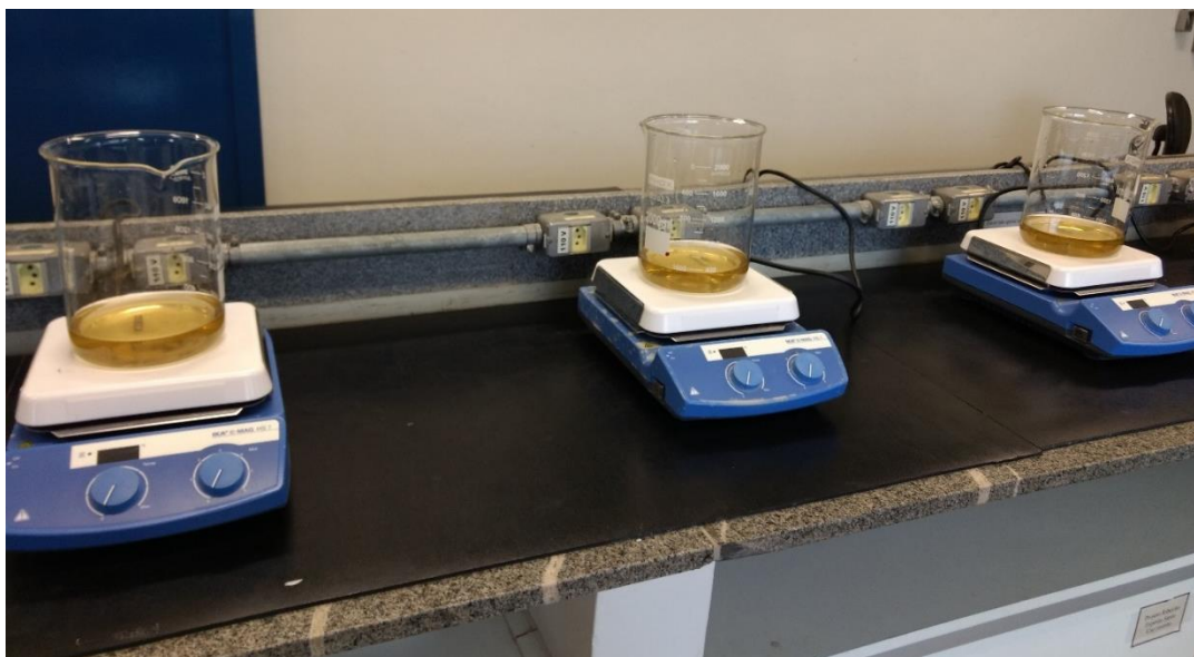
Figura 6 - Foto dos ensaios de precipitação química de Estruvita.
