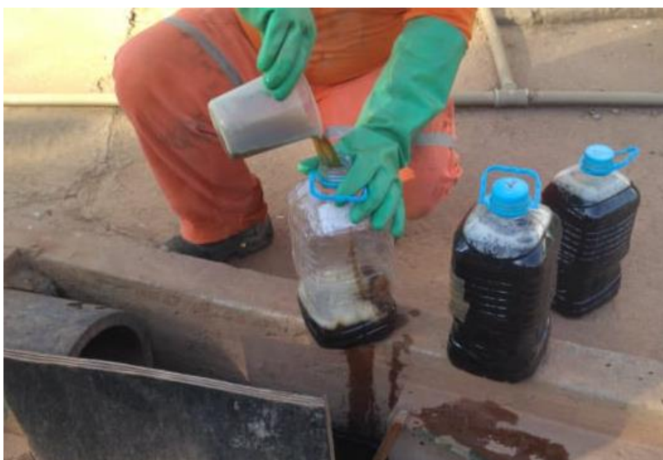
Figura 4 - Coleta do lixiviado no aterro sanitário.
