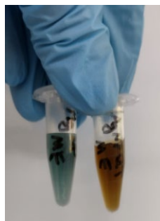
Fotografia 3 – Colóide de nanopartículas de prata sem quitosana (à esquerda) com quitosana (à direita)
