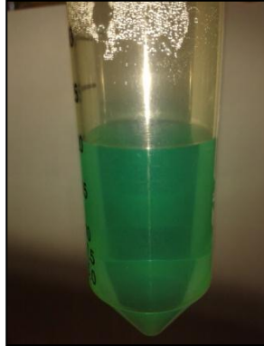
Figura 5: Digestão total por micro-ondas da amostra de aço-inoxidável.
