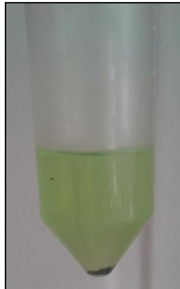
Figura 4: Resíduo gerado na digestão assistida por radiação micro-ondas pelas condições apresentadas na Tabela 1.
