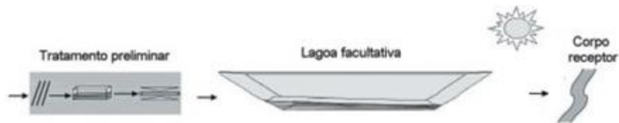
Figura 5.1 - Fluxograma simplificado de lagoa facultativa (Adaptado ReCESA, 2008).
