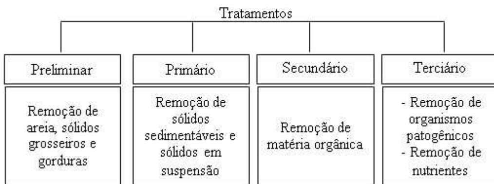
Figura 3.1 - Descrição dos níveis de tratamento dos esgotos.
