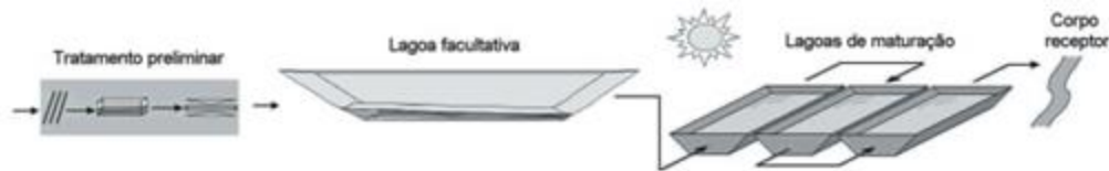
Figura 5.3 - Fluxograma simplificado de lagoa facultativa seguida de lagoa de maturação (Adaptado ReCESA, 2008).
