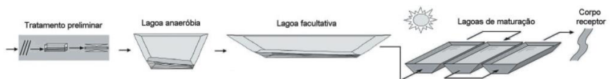
Figura 5.2 - Fluxograma simplificado de lagoa anaeróbia seguida de lagoa facultativa e lagoa de maturação (ReCESA, 2008).
