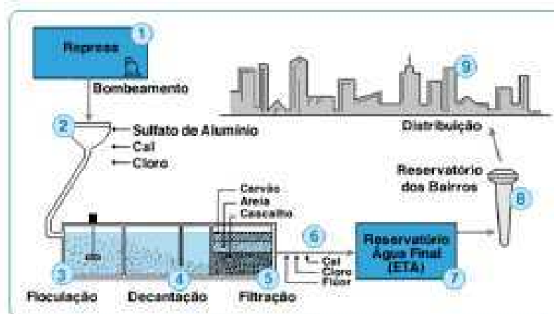
Figura 1 – Sistema de Abastecimento de Água
