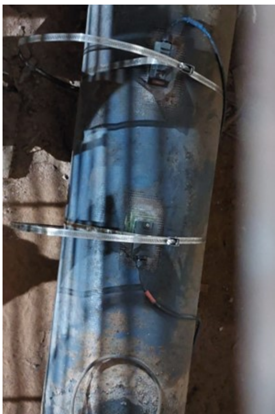
Figura 32 – Metodologia de medição de vazão período de determinação - ETA I
