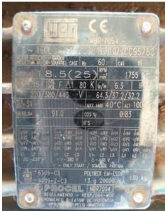
Figura 12 – Dados de placa do motor atual - ETA II
