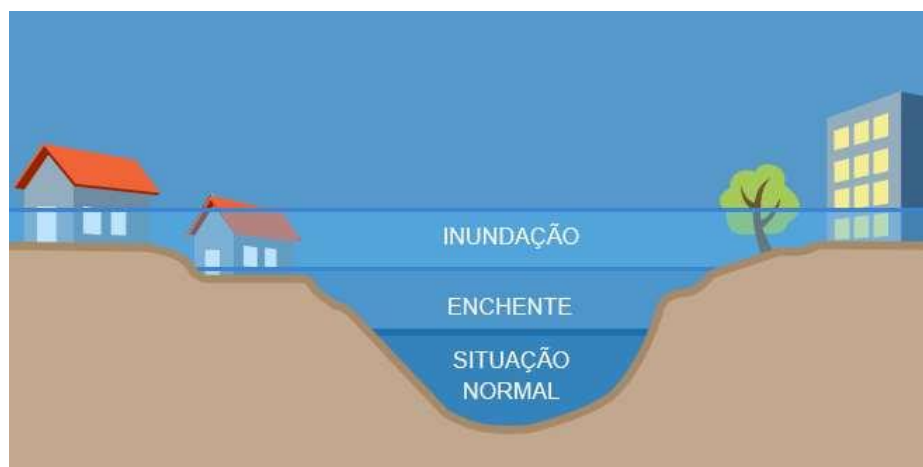
Figura 2 – Perfil esquemático da calha de um canal e dos processos de enchente e inundação
