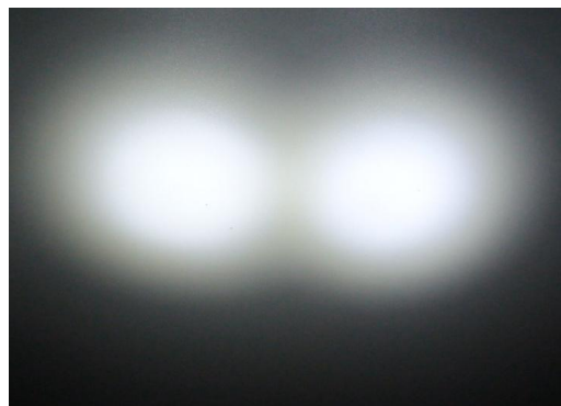
Figura 25 - Dois LEDs de alto brilho com separação entre eles maior que d_{max} .
