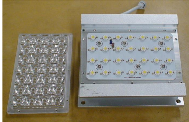
Figura 21 - Módulo de LEDs da luminária HEXALED modelo HEXA LUM BL1 de 35 W.
