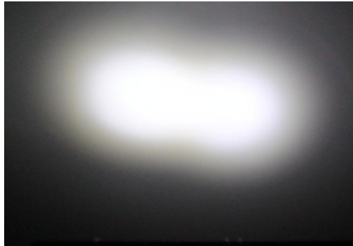
Figura 24 - Dois LEDs de alto brilho com separação entre eles igual a d_{max} .
