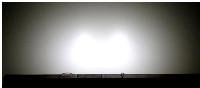
Figura 26 - Dois LEDs de potência com separação entre eles igual a d_{max} .
