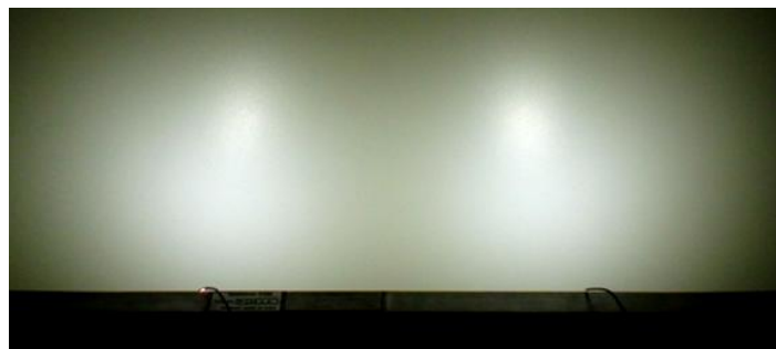
Figura 27 - Dois LEDs de potência com separação entre eles maior que d_{max} .
