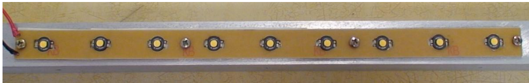
Figura 40 - LEDs montados sobre a barra de alumínio.
