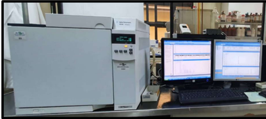
Fotografía 15. Cromatógrafo FID con columna CP Sil-88 (100m * 0.25mm *0.2 µm; Varian Inc; EUA )
