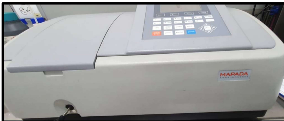
Fotografía 11. Espectrofotometro UV/VIS UV-3300 MAPADA
