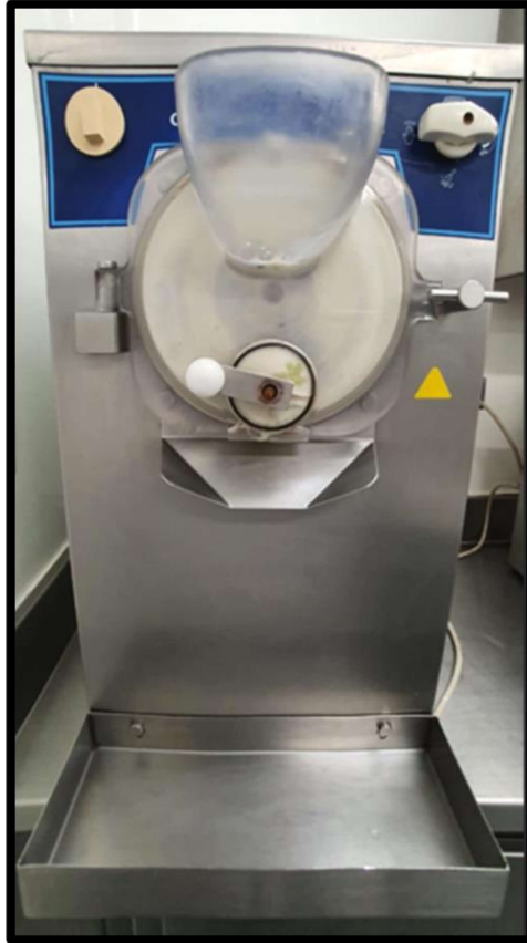
Fotografía 7. Incorporador de aire Labo 8/12 E CARPIGIANI
