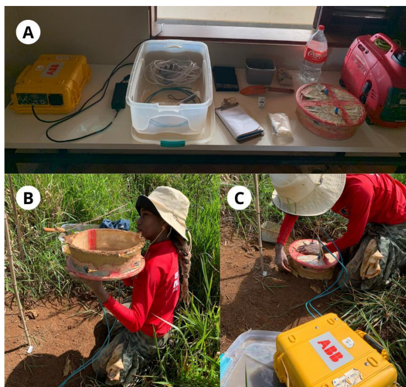
Figura 4: Instrumentos utilizados em campo, equipamento de medição dos fluxos de gases ( Los Gatos Research Inc ), tablet, câmara escura, tubos, argila, pá, termômetro e gerador (A). Procedimentos pré medição dos fluxos, registro de ar atmosférico e vedação da câmara no solo com argila (B e C). Imagens domínio da autora.
