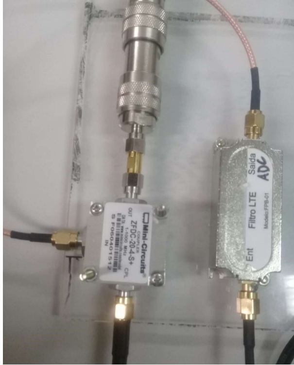
Figura 20 – Acoplador na entrada do receptor
