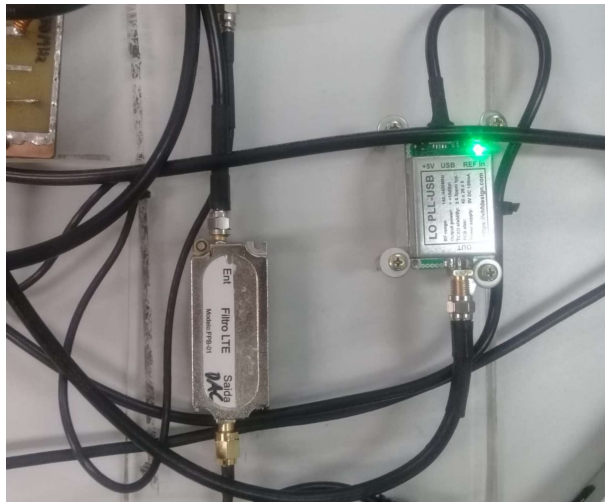
Figura 15 – Oscilador local e o seu filtro de linha
