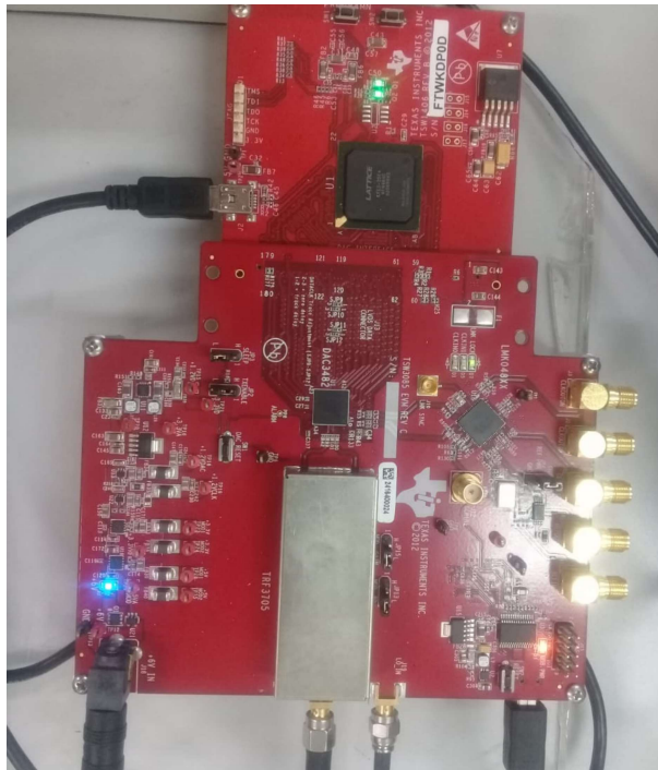
Figura 14 – Placa FPGA com os componentes do transmissor
