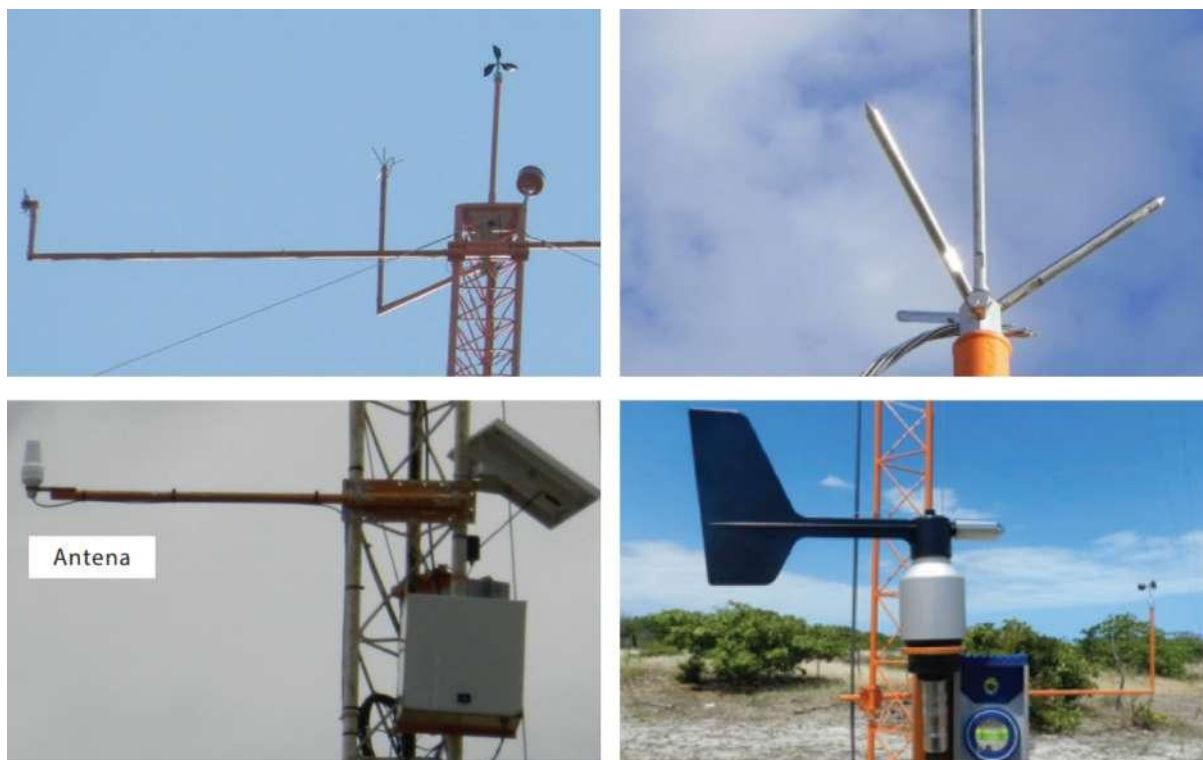
Figura 90 – Fotografias de uma torre anemométrica.
