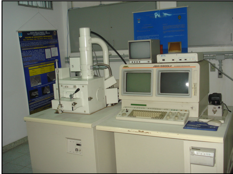
Fotografia 14 – Microscópio eletrônico de varredura marca JEOL® modelo JSM – 5800 LV do Laboratório de Microscopia do Instituto Militar de Engenharia do Rio de Janeiro (IME/RJ).
