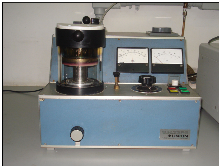
Fotografia 11 – Aparelho Íons Sputter (Balzers SCD 040) marca JEOL® modelo JSM – 5800 LV regulado para 10 kV do Laboratório de Microscopia do Instituto Militar de Engenharia do Rio de Janeiro (IME/RJ).
