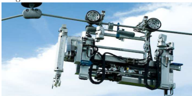
Figura 5: Fotografia mostrando um robô escalador realizando inspeção em uma linha de transmissão de energia
