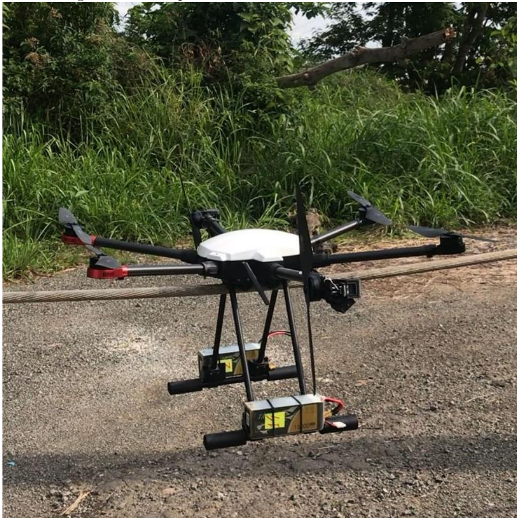
Figura 33: Fotografia do HTR pousado sobre o cabo da linha de transmissão de energia
