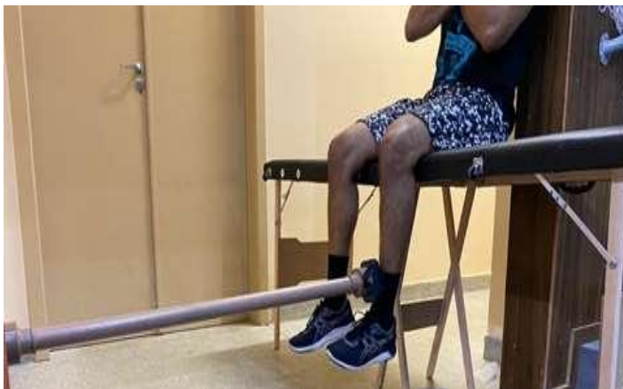
Figura 5 – Dinamômetro PHYSIOCODE F-01 acoplado ao tubo de PVC
