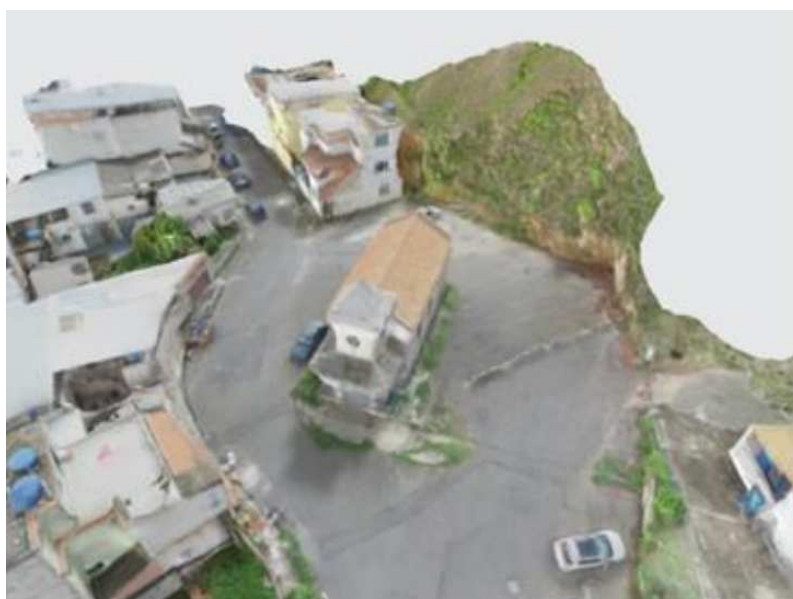
Figura 9 – Modelo geométrico tridimensional obtido por escaneamento 3D a partir do VANT
