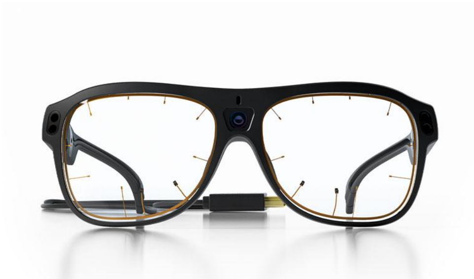
Figura 8 - Exemplo de rastreador ocular usável
