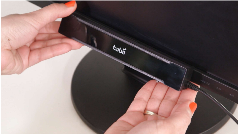
Figura 7 - Exemplo de rastreador ocular baseado em tela
