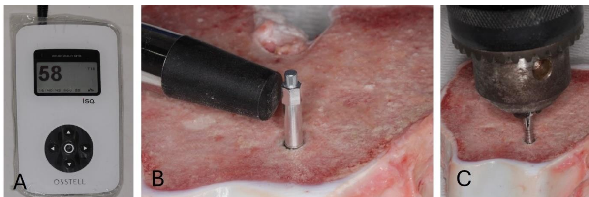
Figura 3 – Equipamento Osstell® Mentor (B) Análise de frequência de ressonância com SmartPeg tipo 53 acoplado ao implante (C) Aferição do torque de inserção
