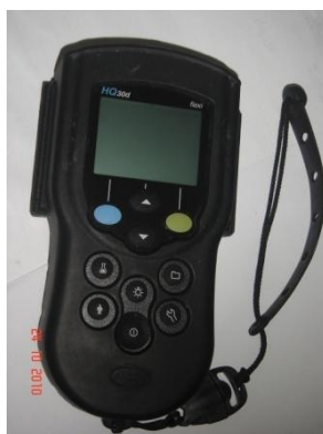
Figura 10: Sonda para medir OD e temperatura da água
