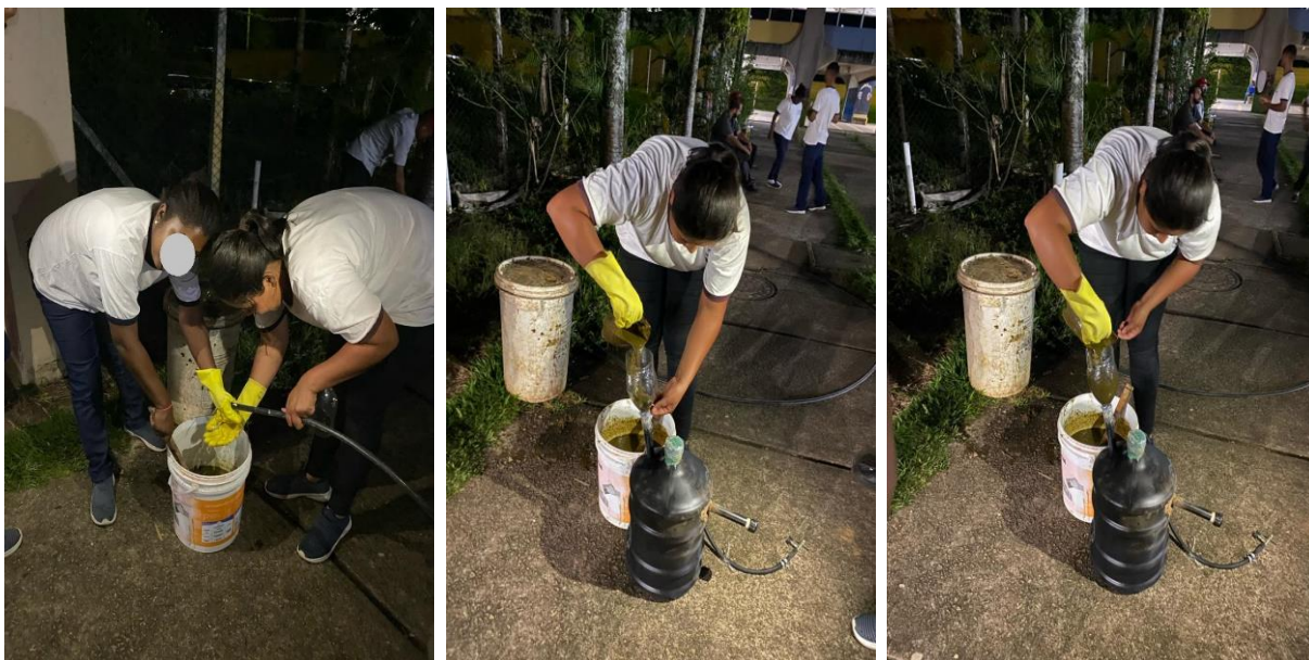
Figura 10 – Abastecendo o biodigestor com esterco bovino
