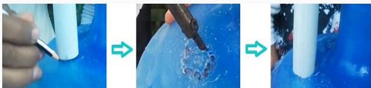
Entrada do Mini Biodigestor
