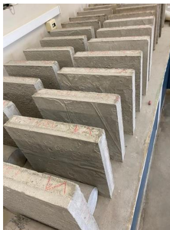
Figura 13 – Corpos de prova para ensaio de condutividade térmica - 300 x 300 x 50 (mm).
