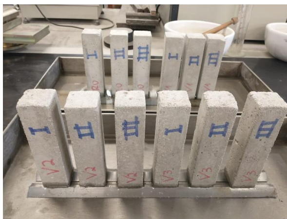
Figura 8 – Ensaio de absorção por capilaridade
