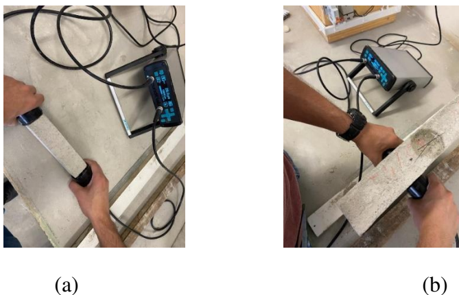
Figura 9 – Medição da velocidade de pulso de ultrassom em barra (a) e em placas (b).
