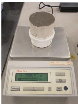
Figura 7 – Ensaio de densidade no estado fresco
