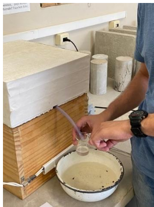
Figura 12 – Medição de massa de água no ATA
