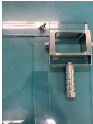
Figura 13 - Dispositivo para laminação dos filmes tópicos.
