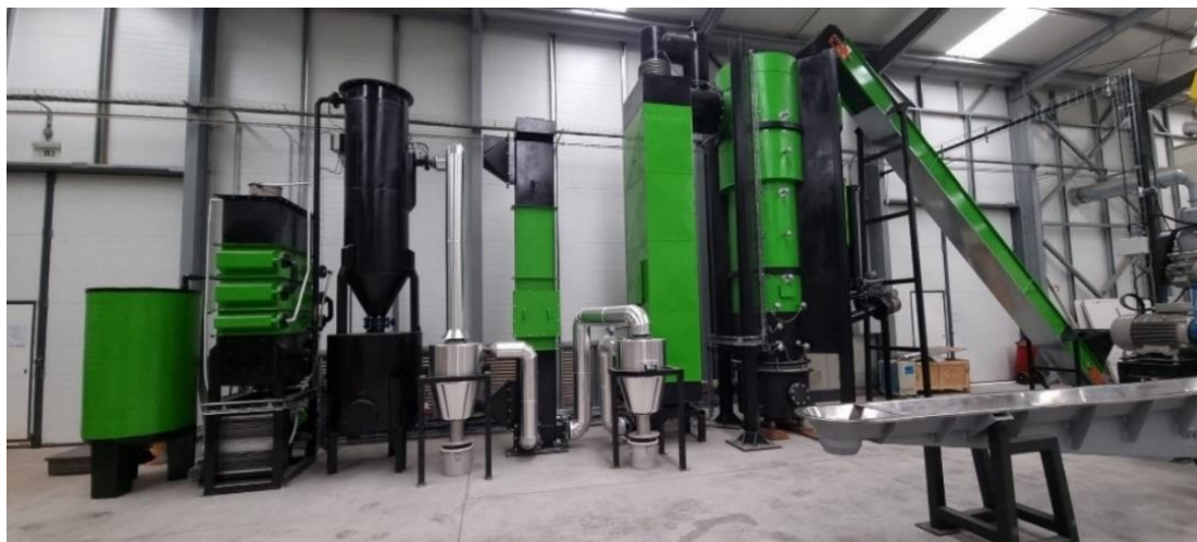
Figura 3. Gaseificador de leito fluidizado borbulhante utilizado nos ensaios.
