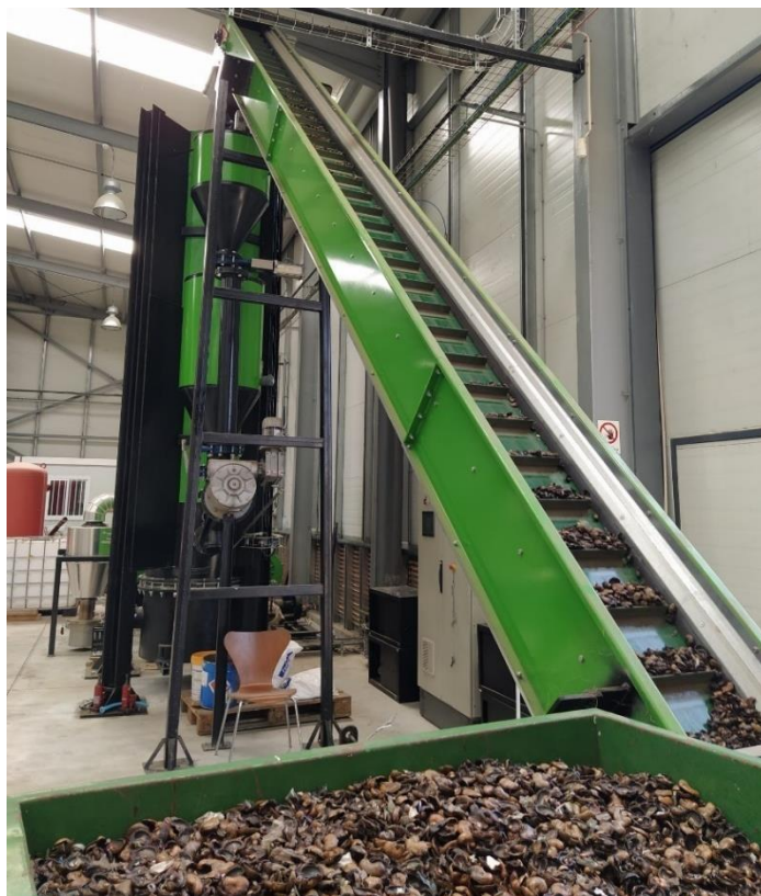
Figura 5. Esteira rolante com os resíduos a serem inseridos no reator.
