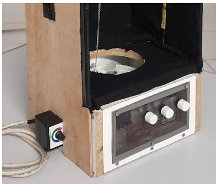
Figura 2 – Regulador de tensão, placa superior da base e motor
