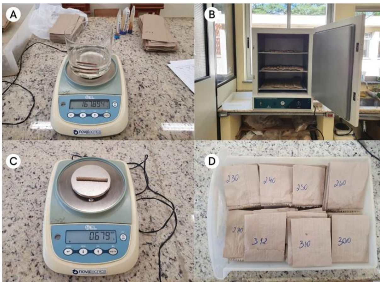
Figura 11 – Processamento das amostras de madeira em laboratório. Laboratório de Ecologia Vegetal UFJF. A: determinação do volume pelo método do deslocamento de água; B: secagem na estufa; C: mensuração do peso seco; D: organização do material testemunho
