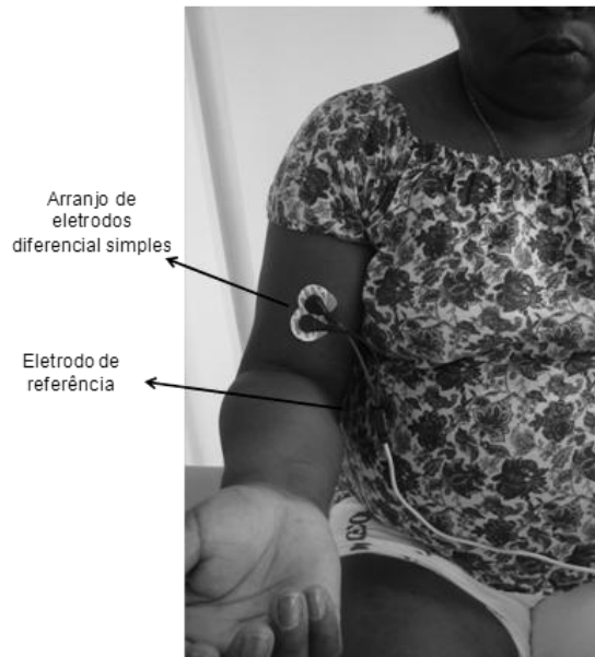
Figura 5.6 – Ilustração do posicionamento dos eletrodos para captação do sinal EMG do músculo bíceps braquial.
