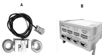
Figura 5.3 – Sistema de Avaliação Muscular Quantitativo (SAMQ): (A) transdutor para tensiometria; (B) conversor analógico-digital de 8 canais.
