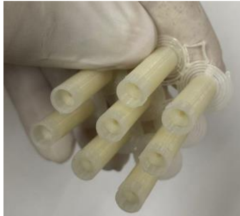
Figura 17 - Suportes de PLA impresso em 3D utilizados na produção dos sensores.
