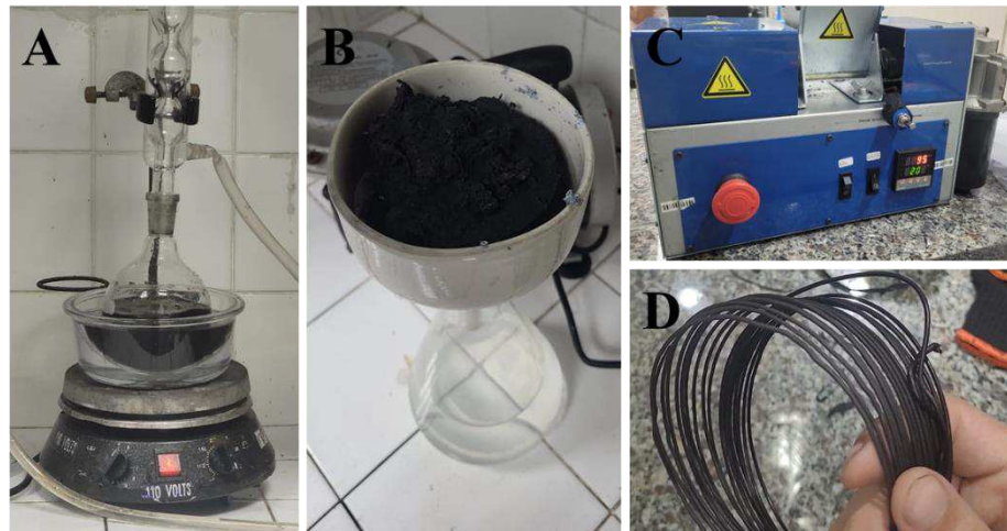
Figura 20 - Etapas da produção do filamento condutivo usado na fabricação dos eletrodos 3Ds-PLA/GRA.
