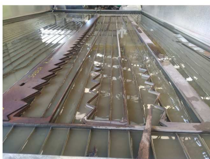
Aparas de chapas inteiras em aço carbono, ainda sobre a mesa de corte do jato de água - Entrevistado 4
