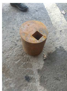
Bloco de teste, feito com corte a jato de água, em chapa de aço carbono com 25cm de espessura - Entrevistado 4.
