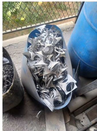
Aparas de chapas em tiras de inox boleadas em estampagem mecânica, separadas para venda como sucata - Entrevistado 3
