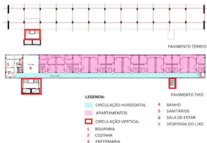
Figura 22. Planta do pavimento tipo e pavimento térreo
