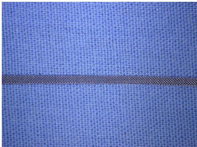
Figura 12: Tela metálica com fios trançados de aço inoxidável com 80 pontos/pol, diâmetro do fio: 0,12mm, Morelli, Jundiaí, BRASIL.
