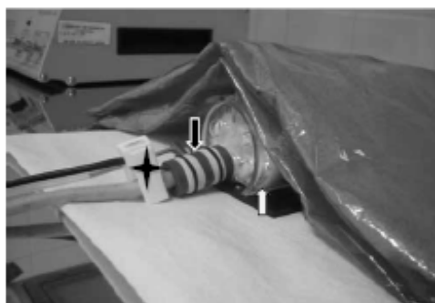
Figura 1: Contensor (seta clara), Manguito (seta escura) e sensor (estrela) colocados na cauda do animal.
