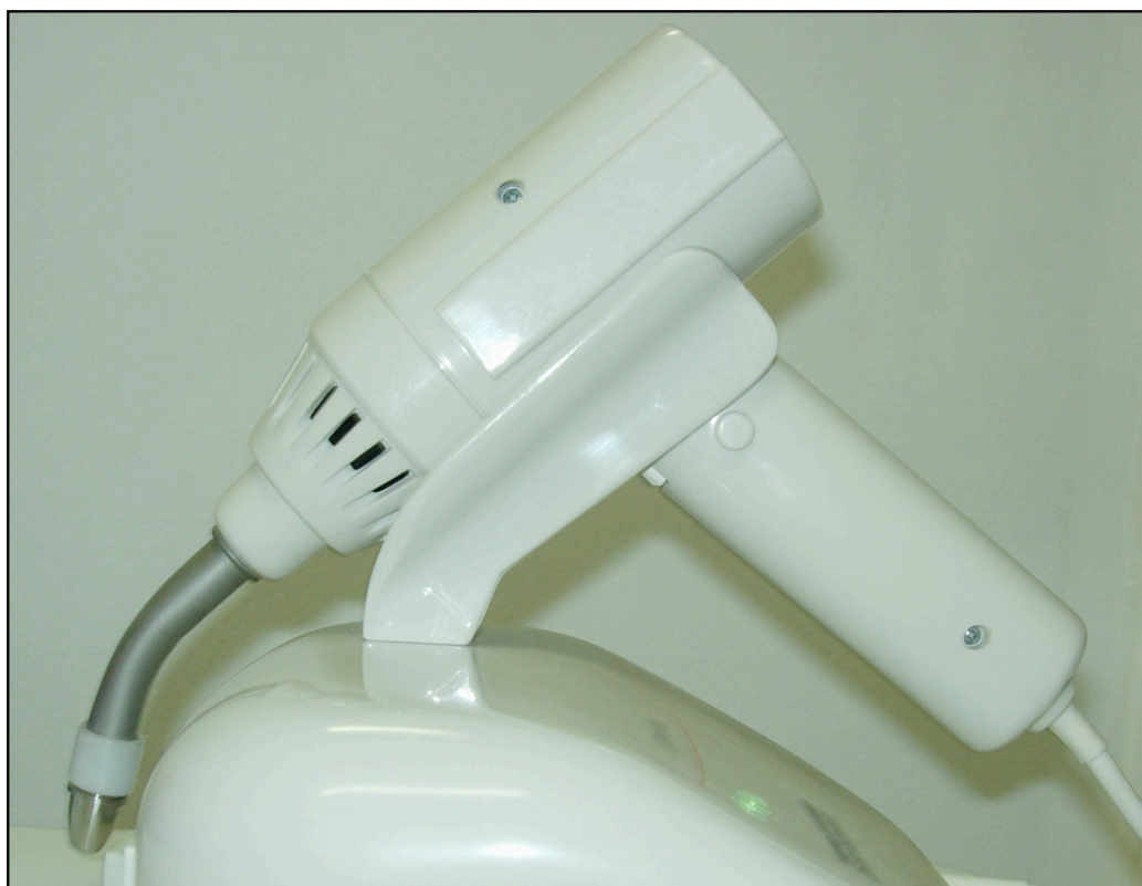
Figura 15: Fotopolimerizador Dabi Atlante® Ultralux com ponteira acoplada utilizada na fotopolimerização das resinas do subgrupo H2.
