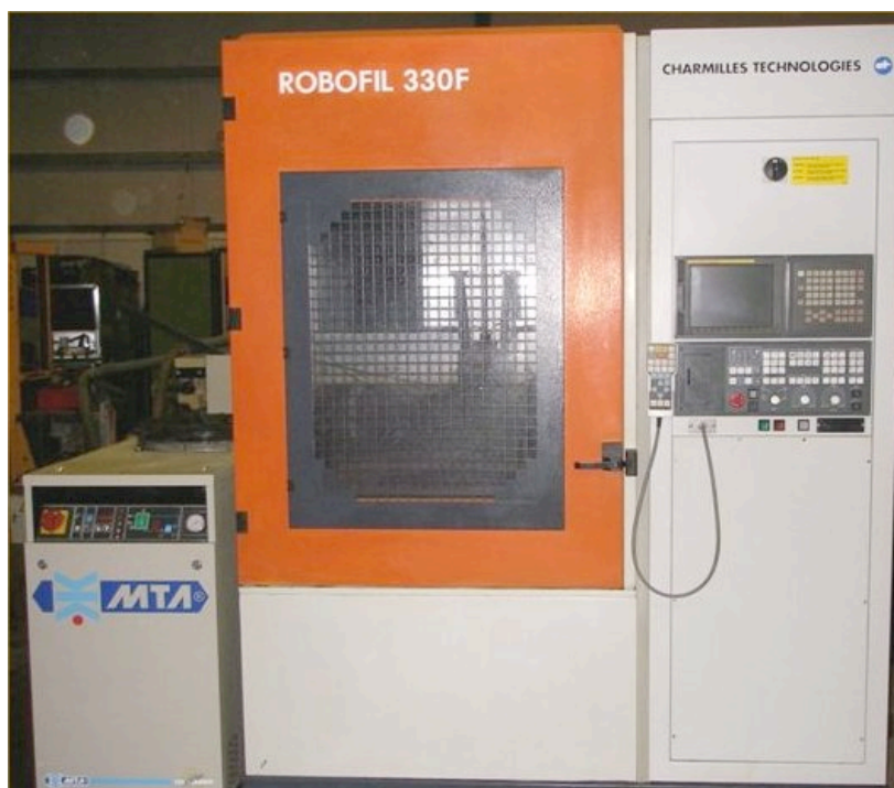
Figura 11: Máquina de usinagem por Eletroerosão da marca Charmilles Technologies modelo Robofil 330F http://www.edm.co.uk/images/Robofil%20330F%202000%20last.JPG (acessado em 13/01/12)
