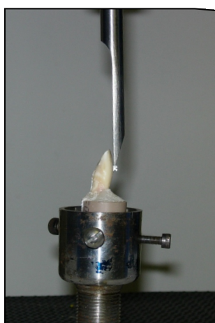
Figura 24: Ensaio de resistência ao cisalhamento. Força no momento da ruptura corresponde à força máxima.
