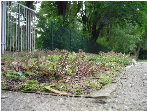
Figura 6: Experimento de mantas com espessuras mínimas (5 cm) no IASP/HU- Berlin. Fonte: Rola (2008).
