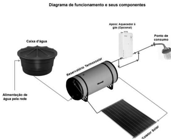
Figura 19: Exemplo do sistema boiler.
