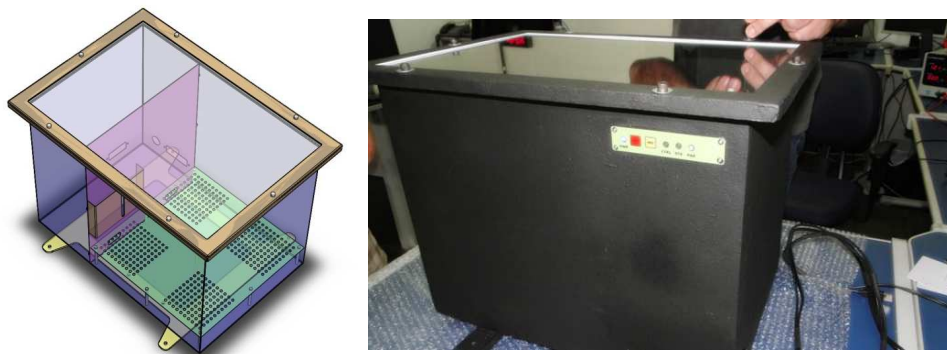
Figura 27 – Visão geral do gabinete de aquisição de dados radiométricos
