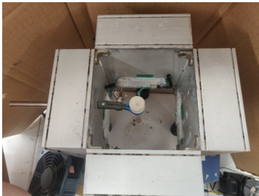
Figura 21 - Configuração interna do fotorreator utilizado na segunda parte do trabalho
