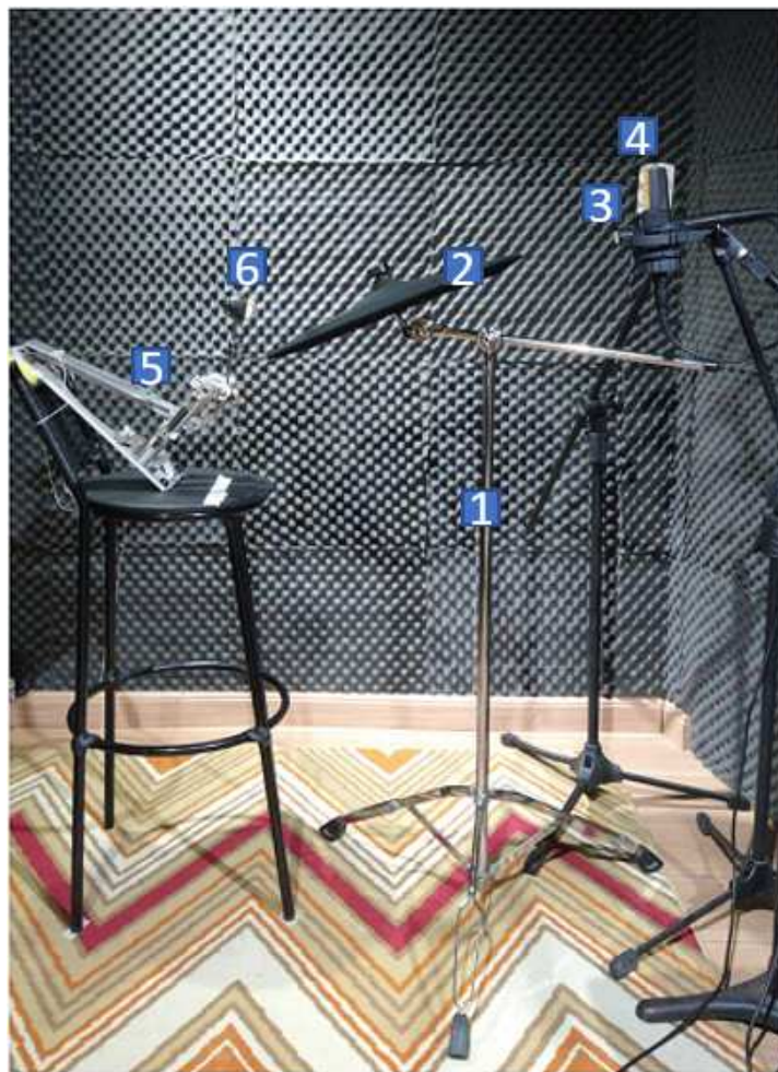
Figura 26 – Configuração do procedimento para a aquisição de dados. 1) Estante do Prato. 2) Prato. 3) Microfone Shure PG 81. 4) Microfone AKG C414 XL II. 5) Pedal de bumbo. 6) Batedor do Pedal.
