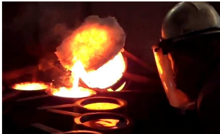
Figura 6 – Metal líquido sendo vertido nas lingoteiras côncavas durante o processo de fundição.
