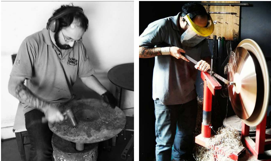
(a) Martelamento manual.
