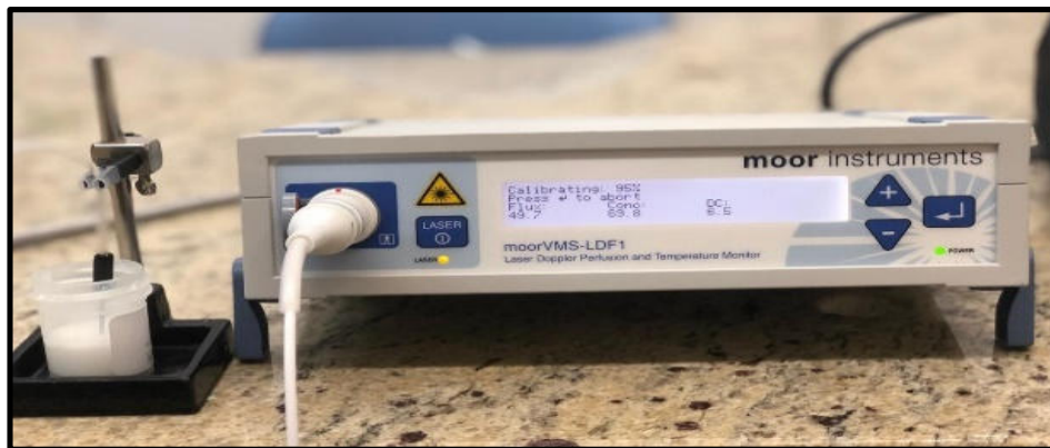
Figura 1: Aparelho sendo calibrado antes da realização do exame Fonte: O autor.
