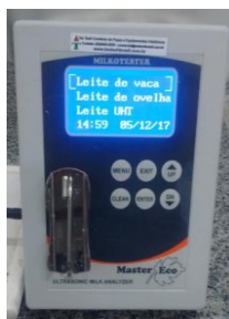
Figura 8 - Analisadores de leite ultrassônicos – Master Mini da empresa Akso.
