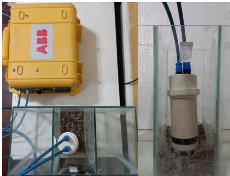
Figura 8: Análise das taxas de emissão de CO 2 e de CH 4 através de um analisador de gases de efeito estufa portátil (Los Gatos Inc.).
