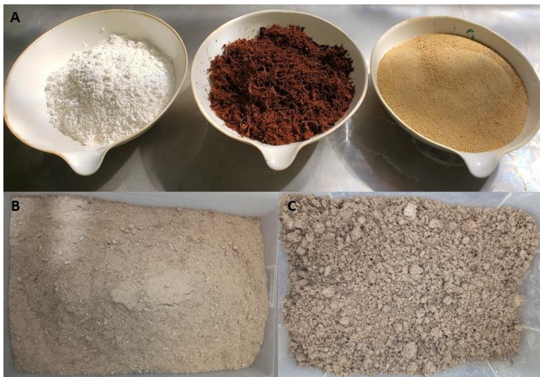
Figura 2: Solo artificial tropical (SAT). (A) Materiais utilizados no preparo do solo artificial tropical, sendo possível visualizar o caulim a esquerda, o pó da fibra de casca de coco ao centro e a areia industrial a direita. (B) Solo artificial tropical seco, logo após a mistura dos materiais. (C) Solo artificial tropical úmido, após a adição de água destilada na proporção de 19,5g de água para cada 100g de solo seco.
