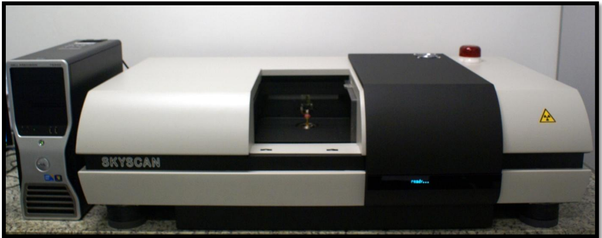
Figura 13 Aparelho de microTC ( Skyscan modelo 1172, Kontich , Bélgica ).
