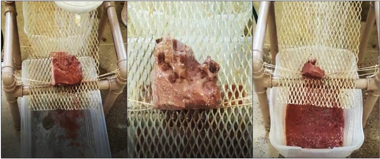
Figura 104 - Comportamento da amostra 3 no ensaio de Inderbitzen modificado
