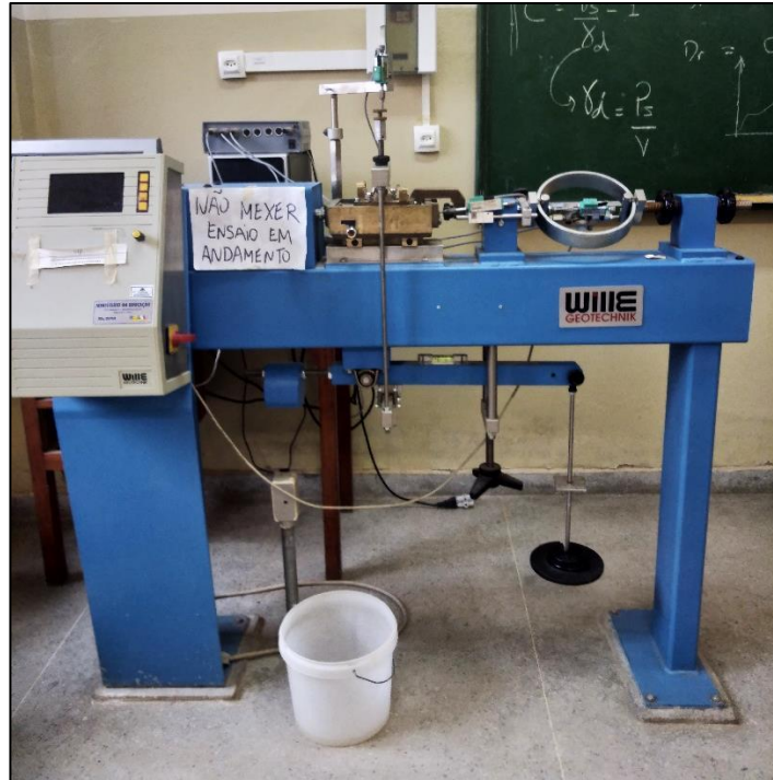
Figura 85 - Equipamento do ensaio de cisalhamento direto
