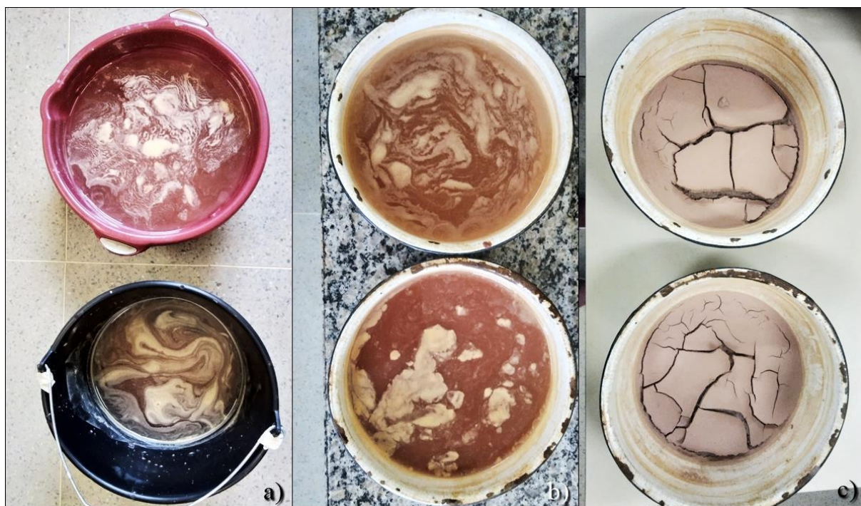
Figura 88 - Recipientes em repouso (a), material que foi para estufa (b) e após secagem (c)
