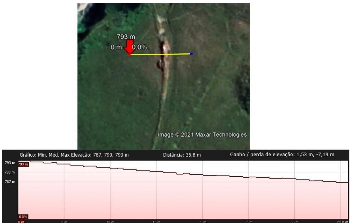
Figura 75 - Perfil de elevação transversal
