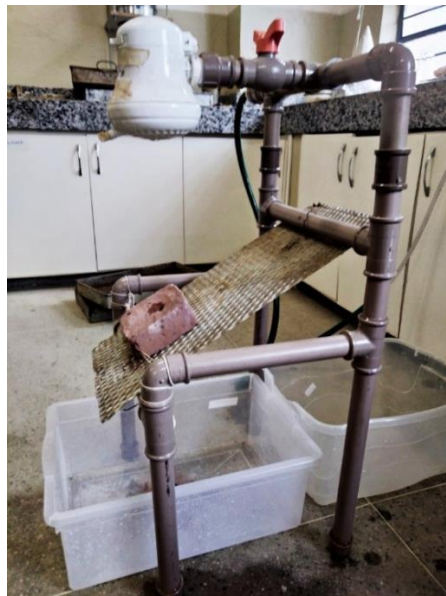
Figura 87 - Equipamento do ensaio de Inderbitzen modificado
