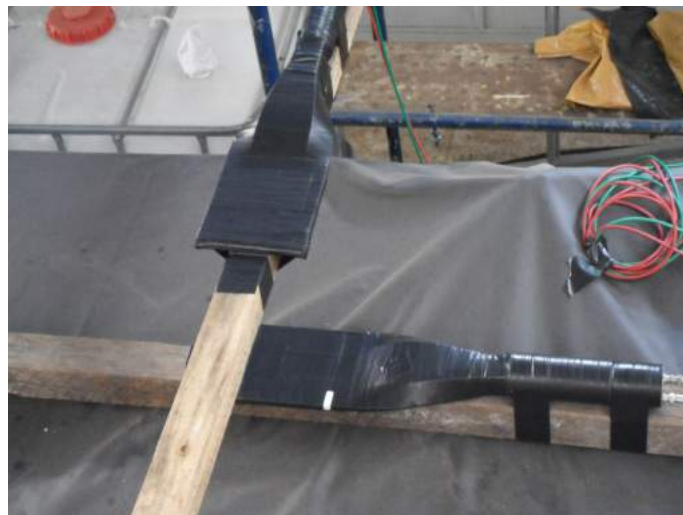
Figura 5.21: Posição das pás cintiladoras sobre o tanque alvo.
