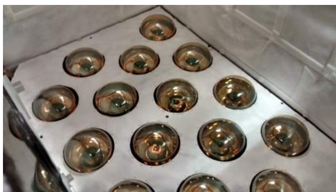
Figura 5.3: PMTs afixadas no face inferior, no interior do tanque central do detector alvo - Foto: Germano Pinto Guedes.
