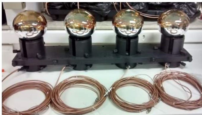
Figura 5.2: Trilho para fixação das PMTs - Foto: Germano Pinto Guedes.
