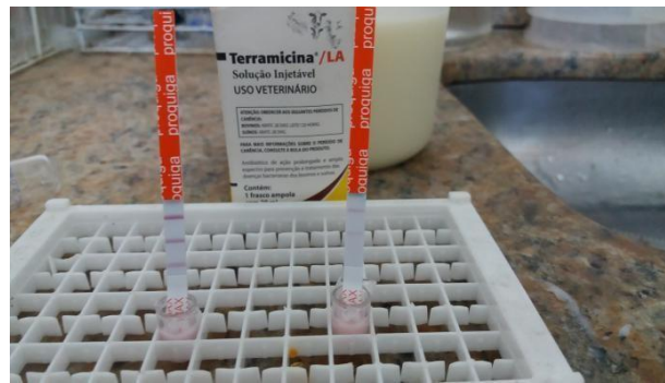
Figura 13: análise do teste imunológico, positivo para terramicina
