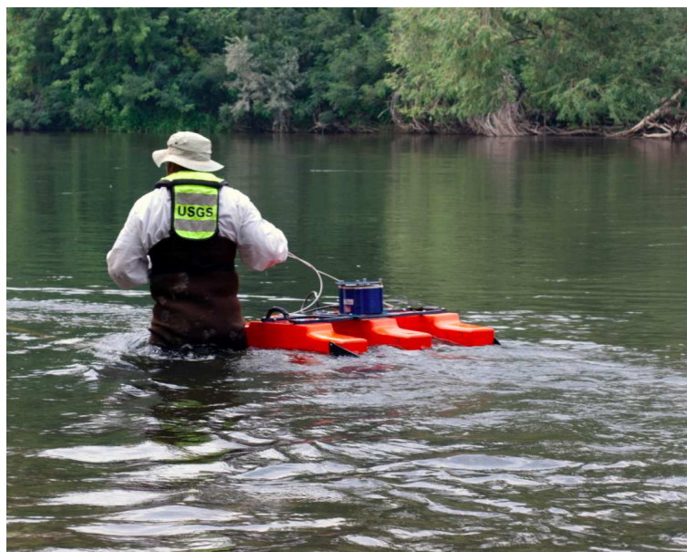
Figura 2: ADCP sendo utilizado para medir correnteza de um rio. Fonte: (MERRICK, 2012).
