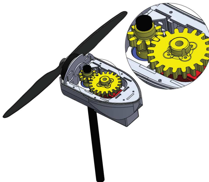
Figura 11: Detalhe do sistema propulsivo aéreo azimutal. Fonte: Autor.
