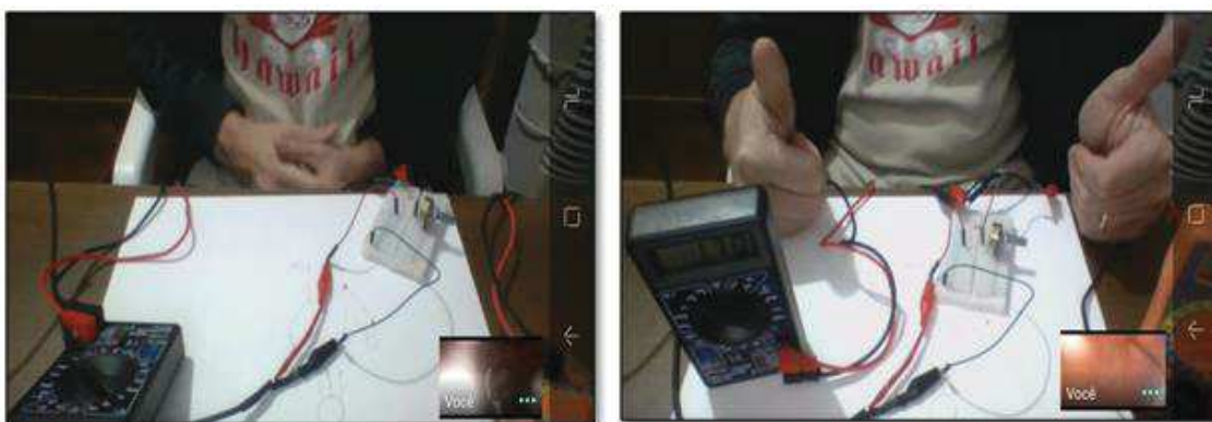
Figura 64 - Professor “E” medindo o potencial de corte de um dos leds
