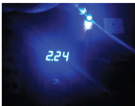
Figura 46 - Planckômetro na função absorção – Led azul sendo iluminado pela caneta laser violeta
